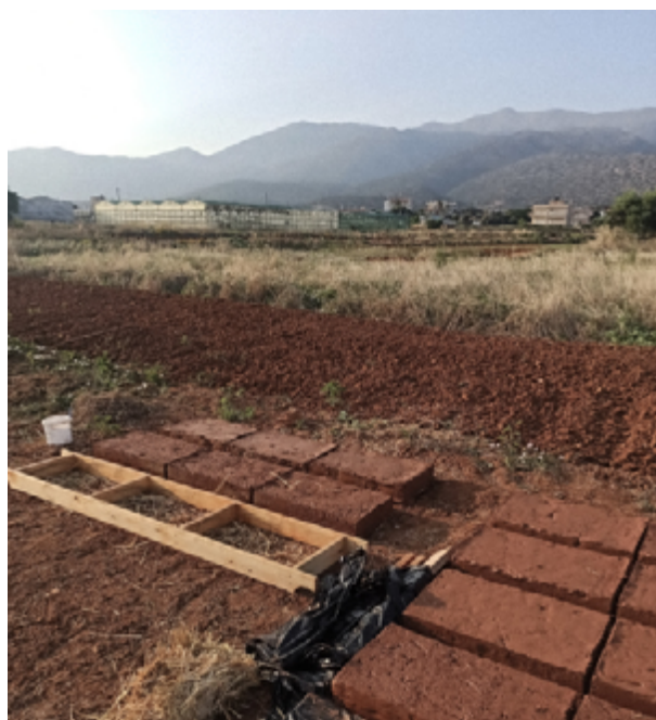
Εικ.16 Εργαστήριο για την κατασκευή πλινθών με πρόσμικτα φύκια, Ιούλιος 2023
